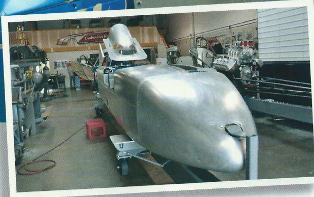
När fronten är helt klar kommer den att ha ett nytt scoop för luften till den främre motorn, utan att vara i vägen för Dannys siktfält. Danny tror att bilen kommer att väga mellan 2 500-2 600 kg, men vikt är inget problem på Bonneville.
