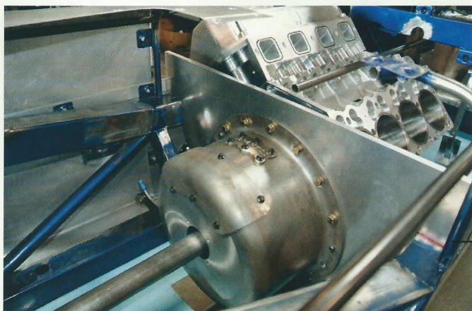
Axlarna med styningen tillverkades speciellt för bilen på 60-talet. De liknar stora Halibrand Quick Change hus och gör det möjligt att snabbt byta utväxling om det skulle behövas.
