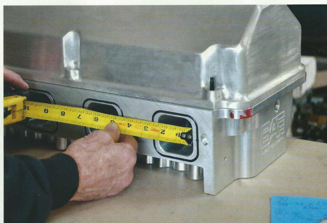
Insugskanaler på de nya BAE topparna är ungefär två gånger två tum med mer gashastighet än de tidigare fuel-topparna. O-ringen runt insugskanaler gör det enklare att skruva då man slipper packningar.
